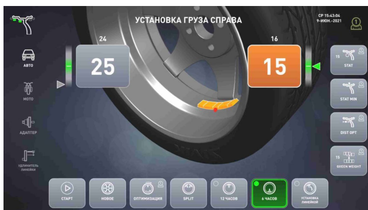
б – установка груза в «6 час»
