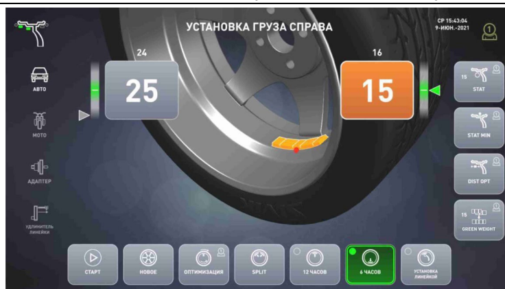
Рисунок 5.8 – Установка в «6 часов» справа
