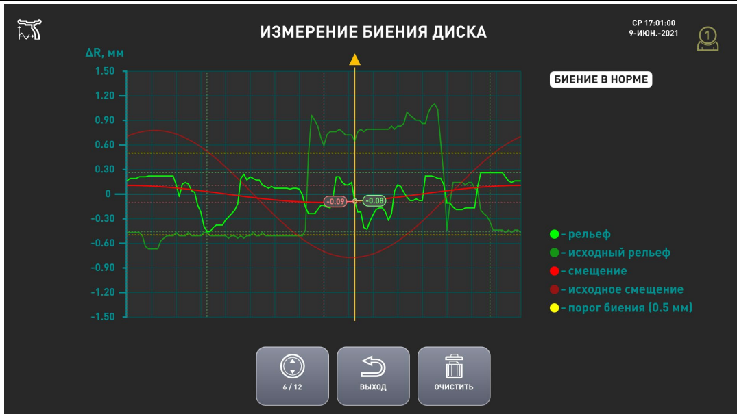
Рисунок 7.9 – Окно сравнения биений диска
