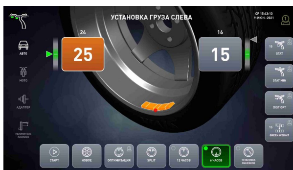
Рисунок 6.10 – Схемы установки грузов
