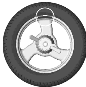
Рисунок 6.5 – Груз установлен в «12 часов»
